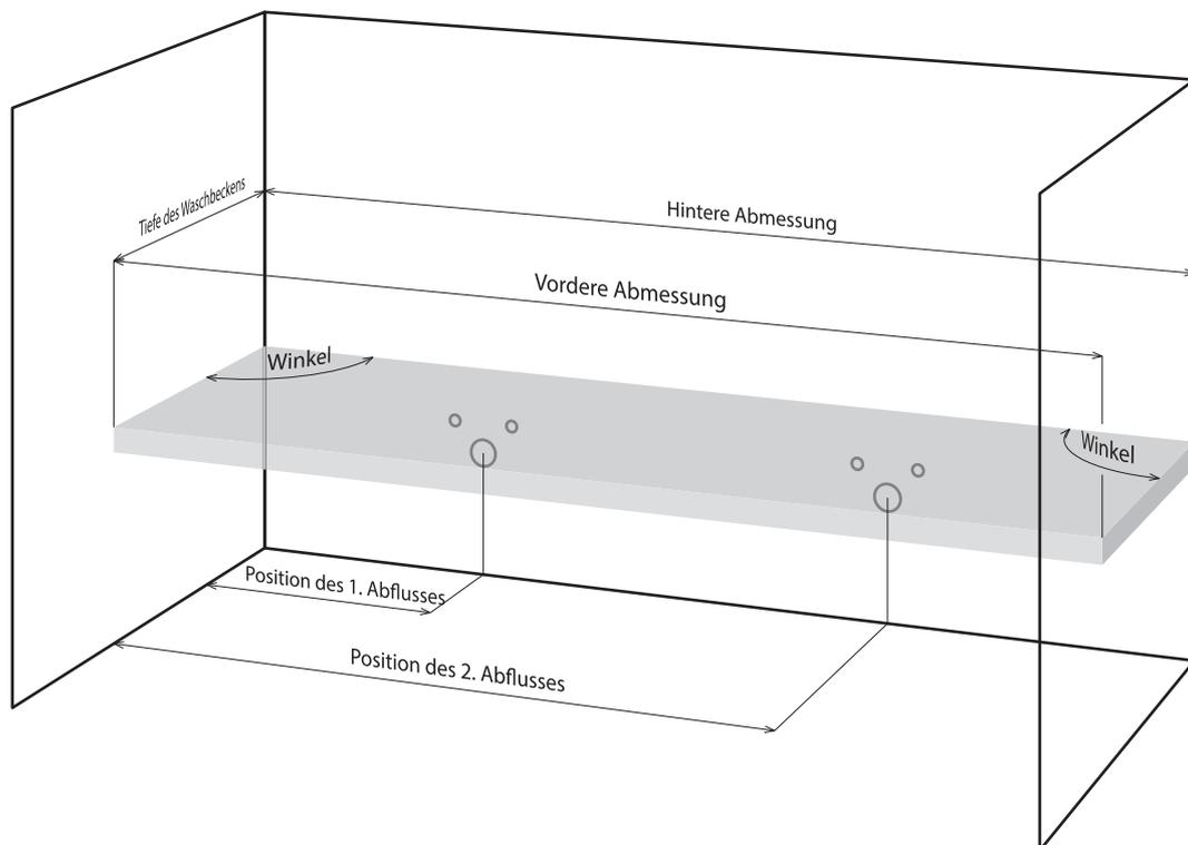
Anm.: Alle angeführten Maße sind in der gewünschten Höhe der Platte zu vermessen. Die übliche Höhe für die Waschbeckenplatte beträgt 850 mm ab dem Fußboden.
