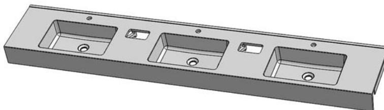
Das **variable System VARIANT** ermöglicht die Herstellung der Waschbeckenplatten mit integrierten Waschbecken aus einem Stück nach Maß **bis zur Länge von 3 900 mm**. Im Falle der Waschbeckenlänge über 3900 mm ist es möglich, unsichtbare Verbindungen direkt vor Montageort durchzuführen. Die Waschstellen können in die Platte fast beliebig platziert werden. Im Angebot gibt es viele Formen. Beispiele für die Grundformen:
